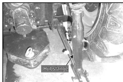
Abb. 4.26d - Verstellbare Hubstange (20)
