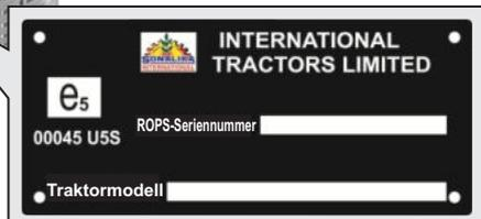
Abb. D: ROPS-Zertifikatschild (EEC)
