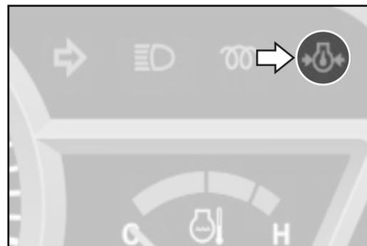
**3.2.10 Überwachungslicht Zapfwelle**
